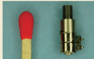
マッチ棒の先ほどのサイズの、小型・軽量マイクロアクチュエータ
